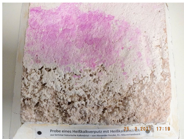
Abb. 2 Probenstück Heißkalkmörtel mit Anstrich aus einem Seminar 2017, das rotviolett der Phenolphthaleinprobe zeigt eine alkalische Oberfläche an (pH-Wert zw. 8,2–13)
