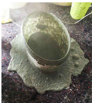
Abb. 20 Blitzartige Reaktion beim Löschvorgang mit 90 °C heißem Wasser
